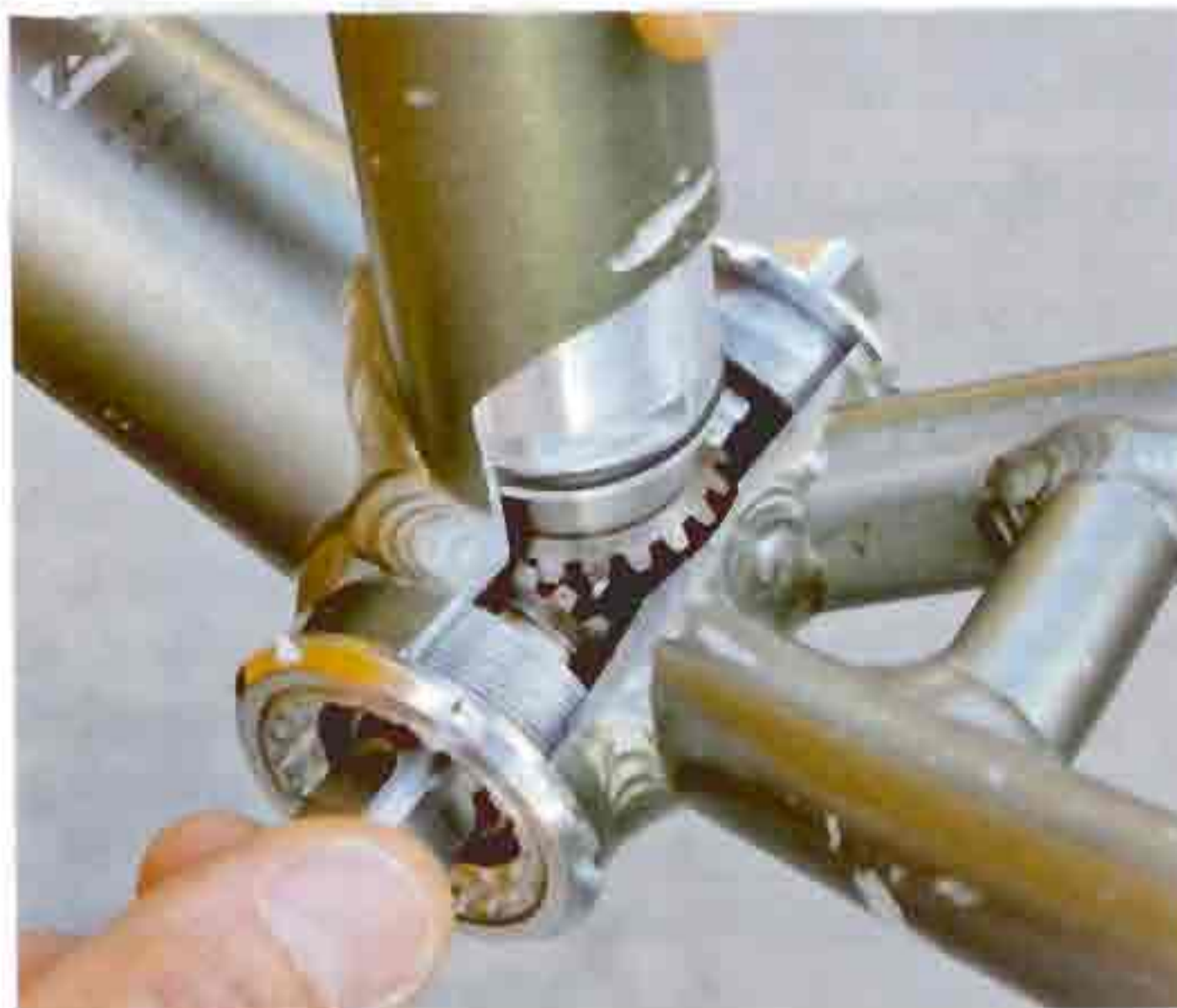
Kraftwerk: Der Gruber-Antrieb sitzt im Sitzrohr und treibt auf Wunsch die Kurbelwelle an.
