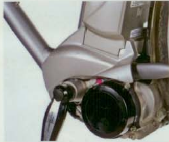
Focus Jarifa Offroad: Pedelec mit dem 250-Watt Mittelmotor von Panasonic.
