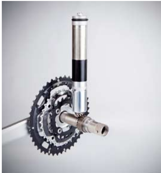
Oben: So ist der Vivax Assist-Motor von außen unsichtbar im Sitzrohr integriert
